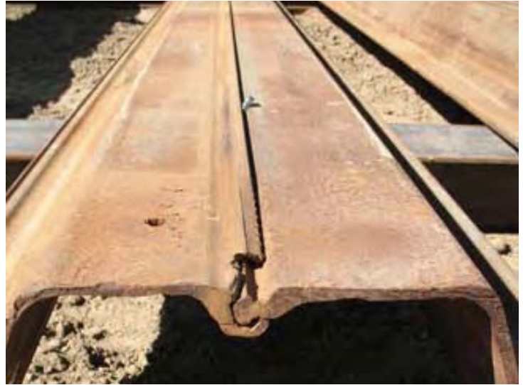
Paired PZ piles.
